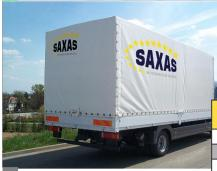
Pritschenaufbau Typ MPB — M passend auf Fahrgestelle 7,49 - 15 t z. GG
