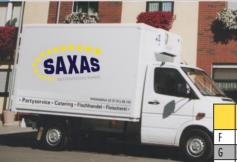
Frischdienst-Kofferaufbauten Typ MKF - L passend auf Fahrgestelle 3,5 - 5,2 t z. GG
